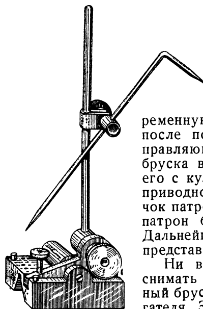
Рис. 54. Рейсмус, используемый для проверки заготовки на биение.
